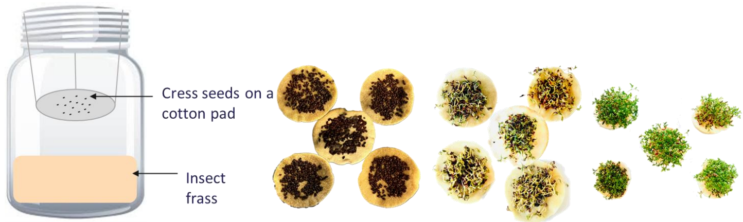
Afbeelding 13: Proefopstelling met tuinkers en voorbeelden van door voer veroorzaakte geremde, gedeeltelijk geremde en ongeremde groei
